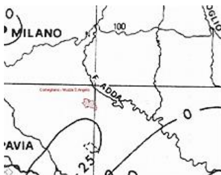
Figura 7: movimenti verticali del suolo dal 1897 al 1957 in mm. (Arca, Beretta – 1985)
